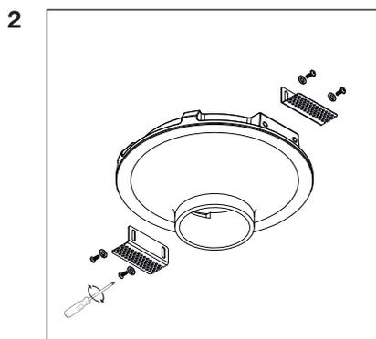
2 Отрегулируйте крепежный элемент (поз. 4) в зависимости от толщины потолка. Закрепите его с помощью винтов (поз. 5) и шайб (поз. 7), идущих в комплекте .
