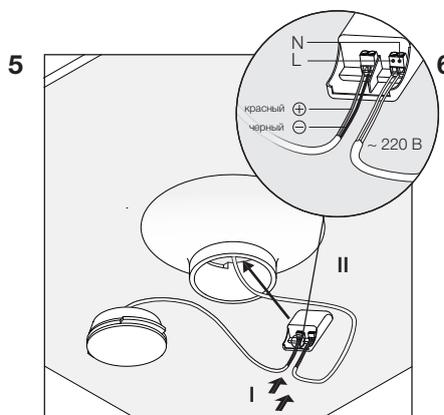
5 Подключите световой модуль (поз. 2) к блоку питания (поз. 3). Блок питания к электросети (см. схему подключения), а затем установите его за гипсокартонный потолок.
