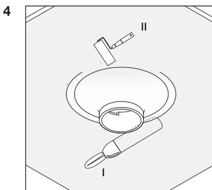
4 После установки следует зашпаклевать швы, покрасить потолок и гипсовый корпус светильника.
