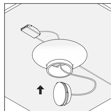
6 Устанавливать световой модуль в корпус следует, предварительно повернув его под 90° от рабочего положения.
