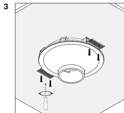
3 Установите корпус (поз. 1) в отверстие и закрепите его с внешней стороны потолка саморезами, идущими в комплекте (поз. 6).
